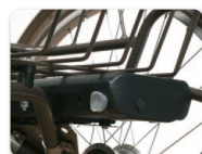
BAT 9-13 baterie elektropohonu
